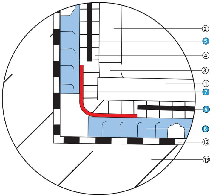
TREP 3.1 dünn-schichtige Beläge mit AquaDrain® Stufendrainage
