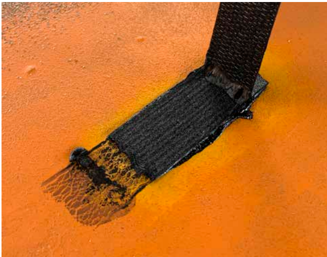
Eine Haftzugprüfung in Form eines Abreißversuch durchgeführt
